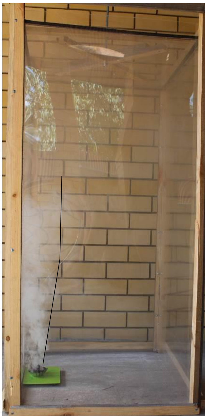
Рисунок 3.8 – Фото характерного распространения дыма внутри экспериментального объема при расположении горючего материала у стены ( h=1,5 м)
