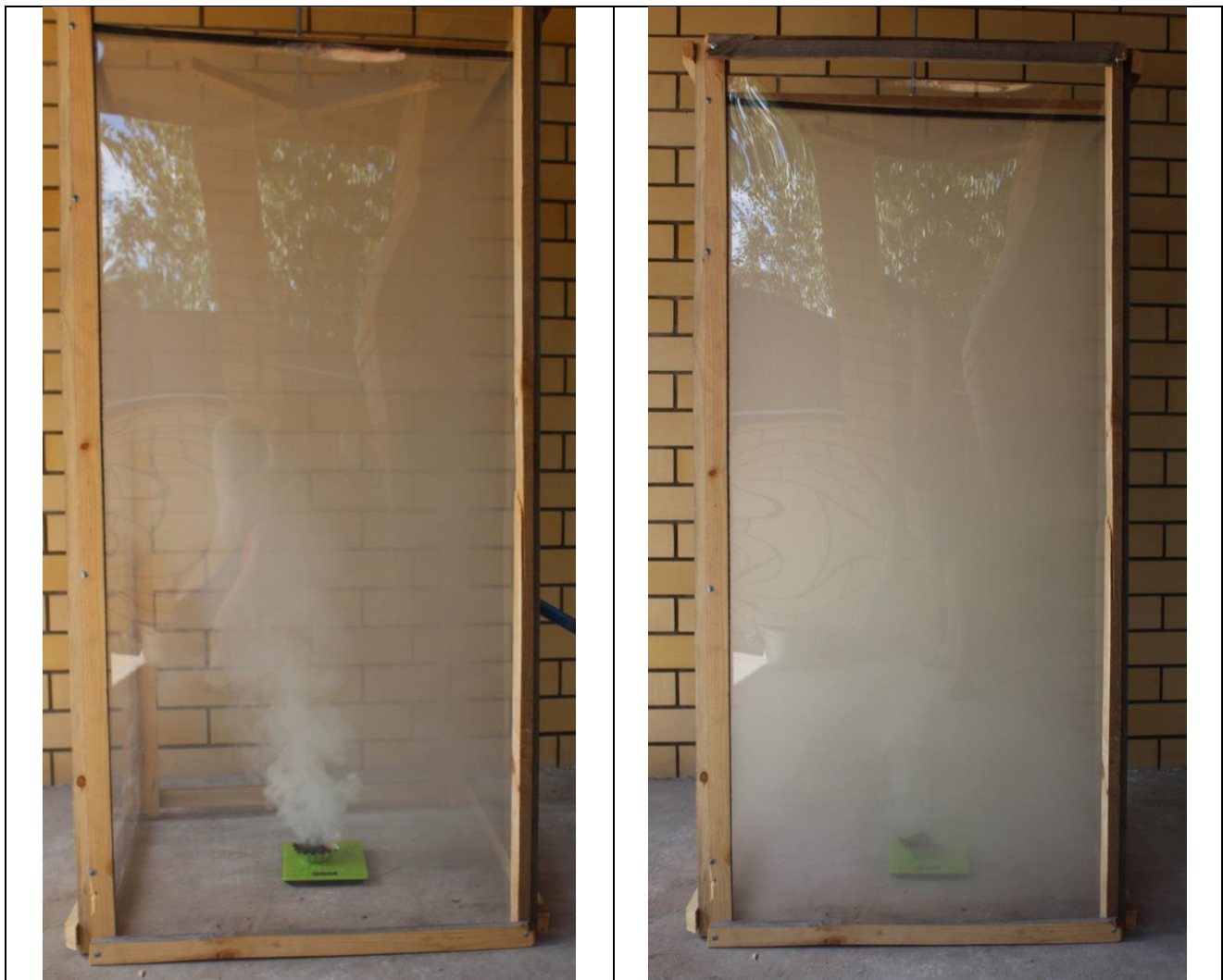
Рисунок 3.4—Фото от начала горения до полного задымления макета помещения
