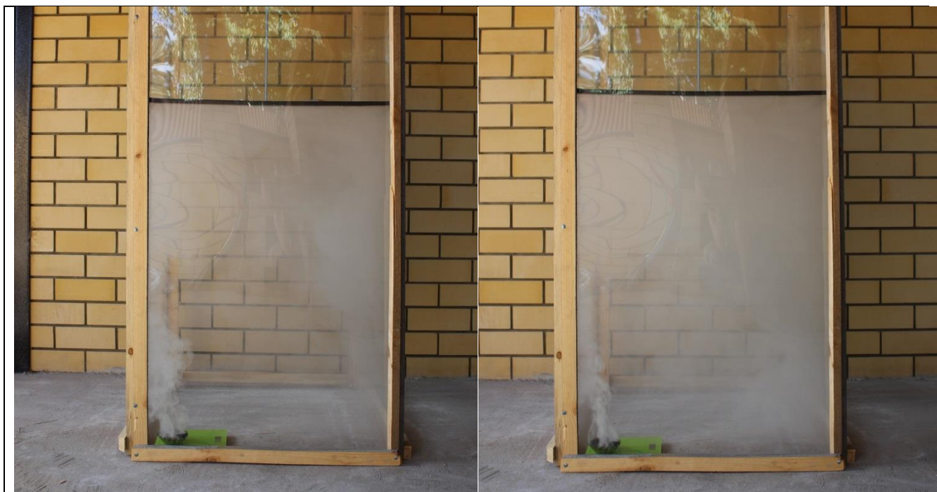
Рисунок 3.5—Распространение дыма при расположении очага горения в углу
