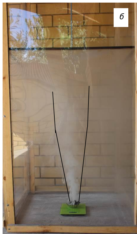
Рисунок 3.9 – Фото характерного распространения дыма внутри экспериментального объема при расположении горючего материала в центре пола
