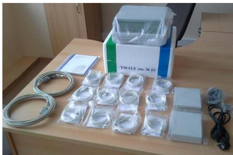
Рисунок 6.9 – Схема расположения термопар на первом уровне и фото термоизмерителя ТМ – 12М
