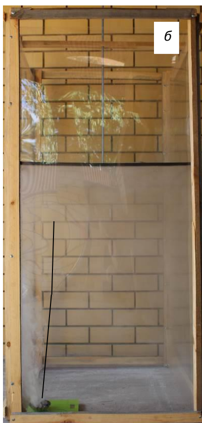
Рисунок 3.10 – Фото характерного распространения дыма внутри экспериментального объема при расположении горючего материала в углу макета
